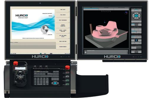
3 Mit der Option ‘Surfacing’ lassen sich mit der Hurco-Steuerung Freiformflächen direkt an der Maschine programmieren
